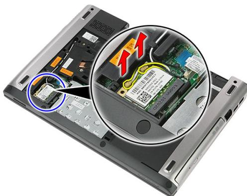
5. Utilizzare un punteruolo per sollevare il dispositivo di rilascio della scheda WLAN.
