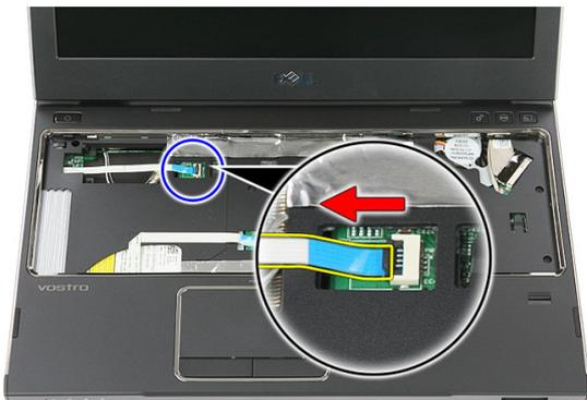
**11.** Aprire i fermi che fissano il cavo della scheda del LED alla scheda di sistema.
