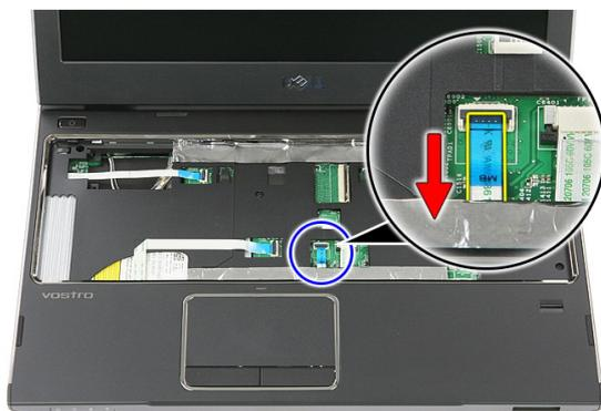
15. Aprire i fermi che fissano il cavo del lettore di impronte digitali alla scheda di sistema.
